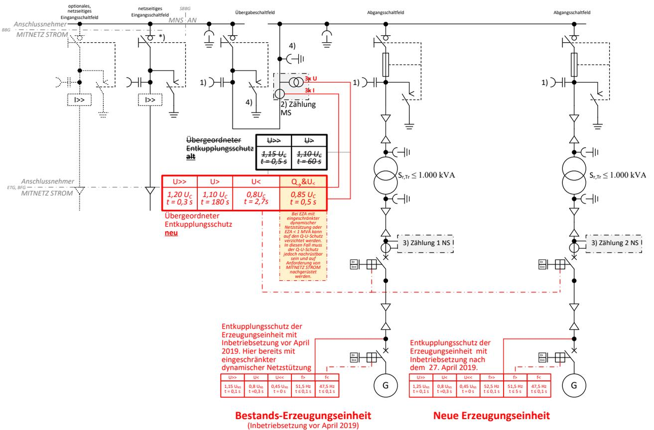
Abb. 27: (ehemals D4b):  $\leq 20$ -kV-Anbindung von zwei Erzeugungseinheiten (Bestands-Erzeugungseinheit; neue Erzeugungseinheit)
