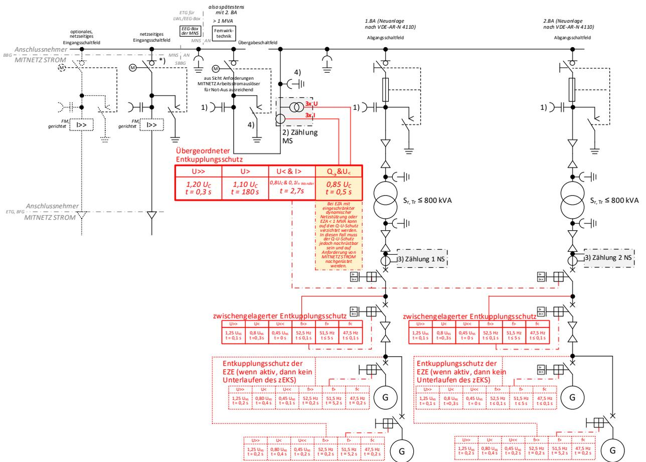
Abb. 30: (ehemals D4e): ≤ 20-kV-Anbindung von zwei Bauabschnitten einer PV-Anlage mit je 750 kVA (spätestens ab 2.BA mit FWT, in diesem Fall im 1.BA mit FRE)
