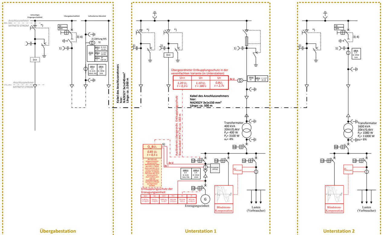
Abb. 35: (ehemals D5e): ≤ 20-kV-Anbindung von zwei Unterstationen mit Blindstromkompensation der Lasten der Bezugsanlage und vereinfachter Variante des übergeordneten Entkopplungsschutz
