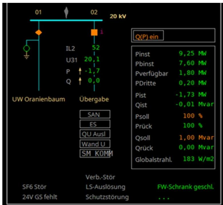
Abb. 20: Beispiel der Darstellung eines MS-Sammelschienen-Anschlusses in einem Umspannwerk im Netzleitsystem der MITNETZ STROM (Die Darstellung eines MS-Netz-Anschlusses erfolgt bis auf Qsoll/Qrück in gleichem Umfang.)
