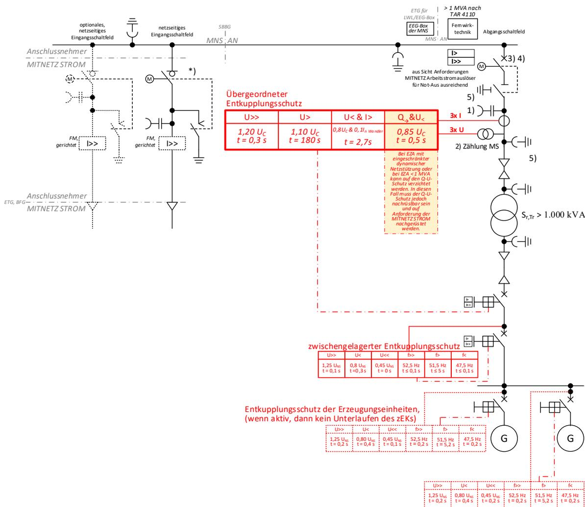
Abb. 29: (ehemals D4d): ≤ 20-kV- Anbindung einer Erzeugungsanlage > 1 MVA
