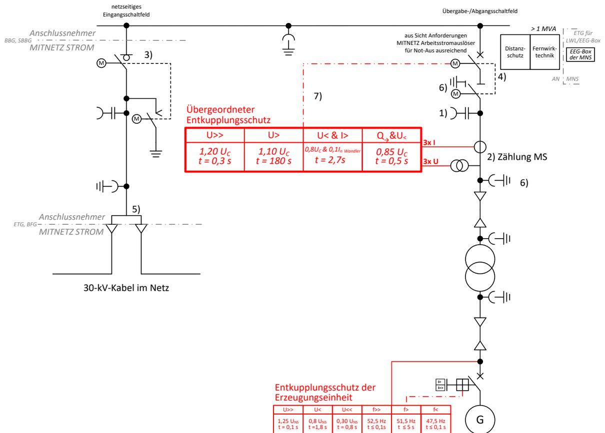
Abb. 36: (ehemals D6): 30-kV-Anbindung einer Erzeugungsanlage im Netz
