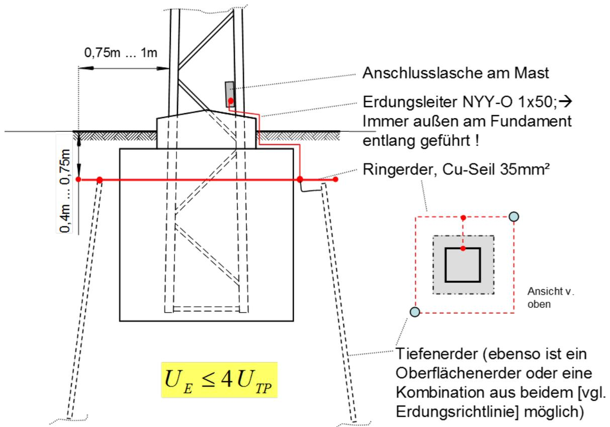
Abb. 7: Standard-MS-Mast-Erdungsanlage
