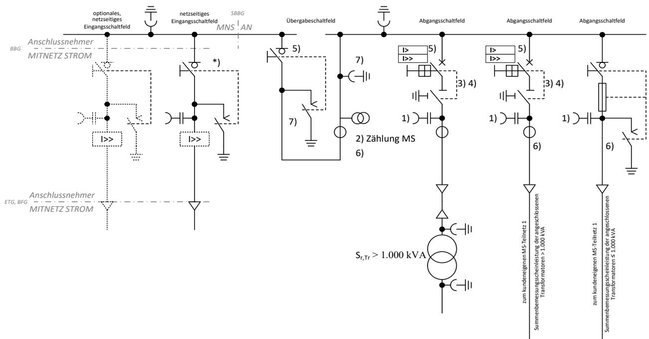
Abb. 24: (ehemals D2b):  $\leq 20$ -kV-Anbindung mit drei Abgangsfeldern (ein Transformator  $> 1$  MVA, zwei Kabelabgangsfelder [kundeneigenes MS-Netz und ein Transformator  $\leq 1$  MVA bzw. ein Transformator  $> 1$  MVA] mit Übergabe-Lasttrennschalter
