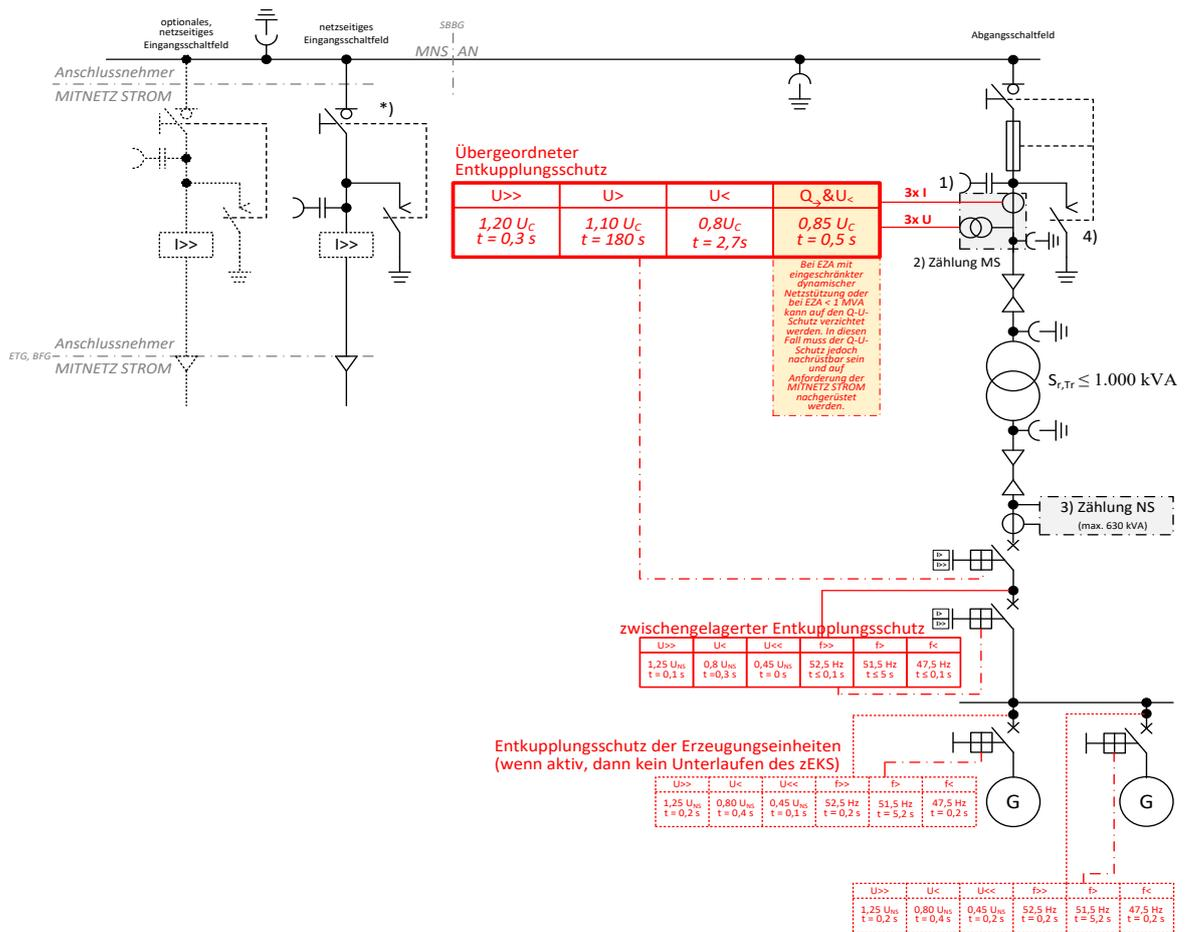
Abb. 28: (ehemals D4c): ≤ 20-kV-Anbindung einer Erzeugungsanlage ≤ 1 MVA
