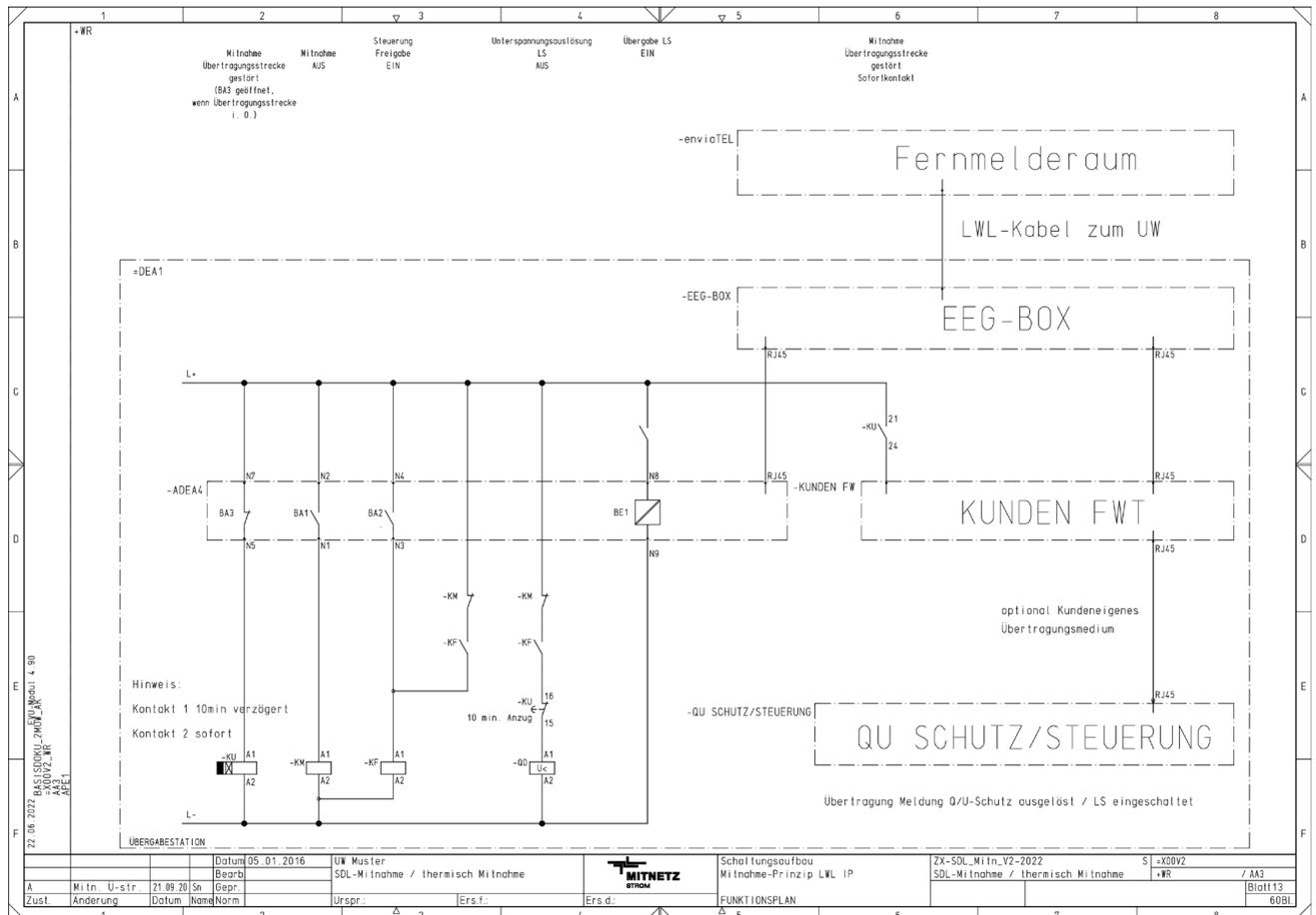
Abb. 49: Schaltungsaufbau der LWL-Kabelverbindung zwischen der Übergabestation und dem MITNETZ STROM-Umspannwerk (Standardfall)
