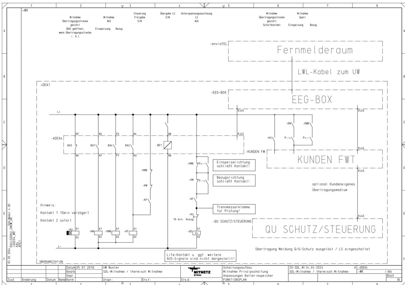
Abb. 50: Schaltungsaufbau der LWL-Kabelverbindung zwischen der Übergabestation und dem MITNETZ STROM-Umspannwerk (richtungsabhängig)
