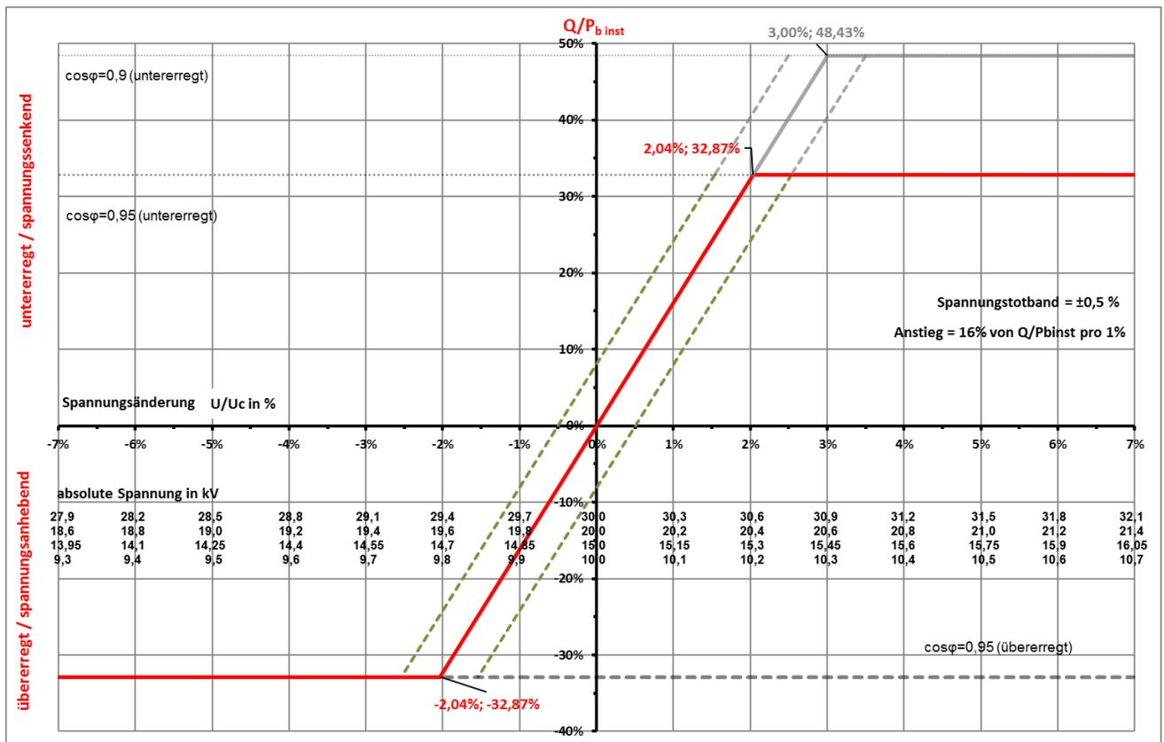
Abb. 12: Standard-Q(U)-Kennlinie (roter Verlauf), ehemals Bild 10.1
