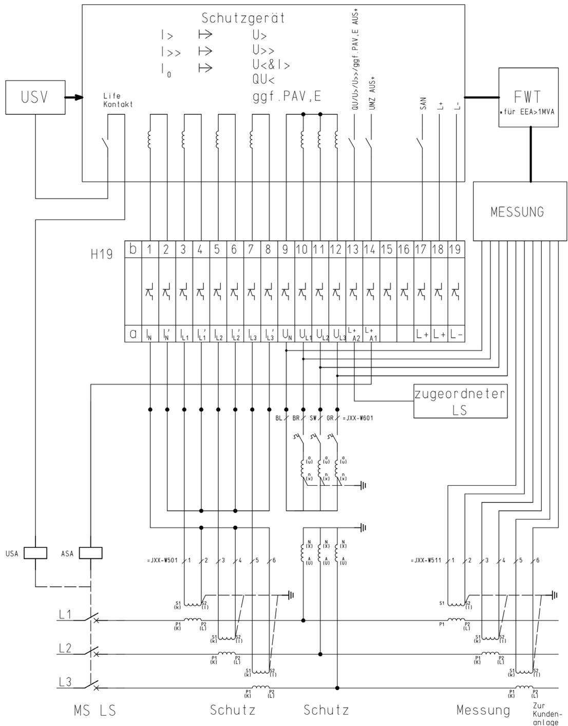
Abb. 44: Wandlerverdrahtung Anbindung UMZ / übergeordneter Entkopplungsschutz
