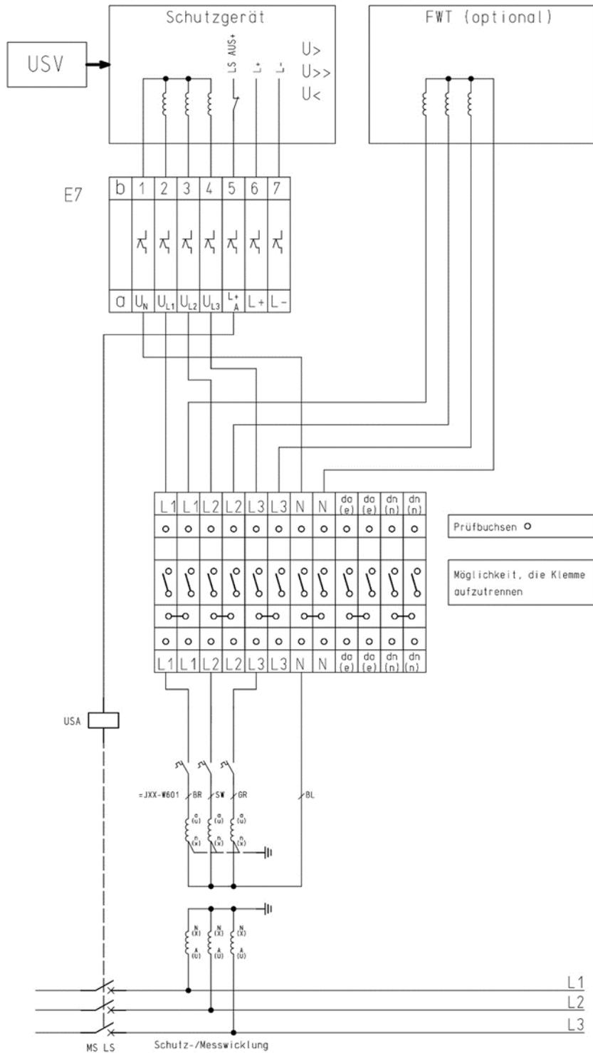
Abb. 46: Wandlerverdrahtung Anbindung übergeordneter Entkopplungsschutz / Fernwirkgerät
