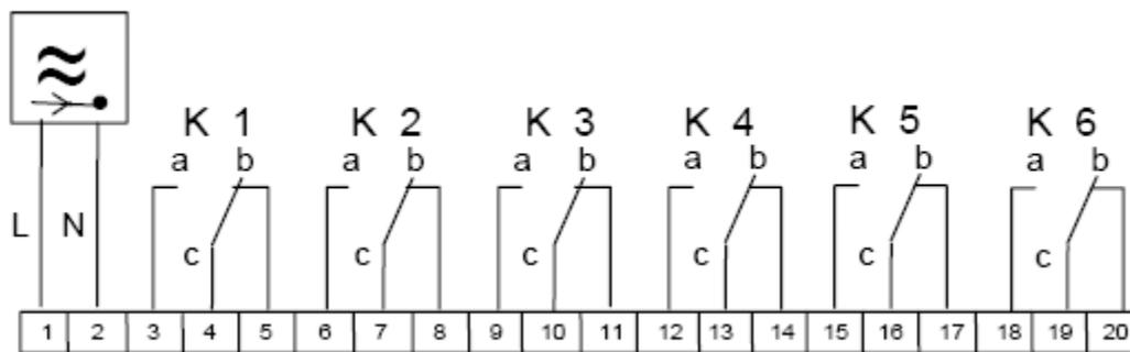
Abb. 16: Relaisplan Funkrundsteuerempfänger
