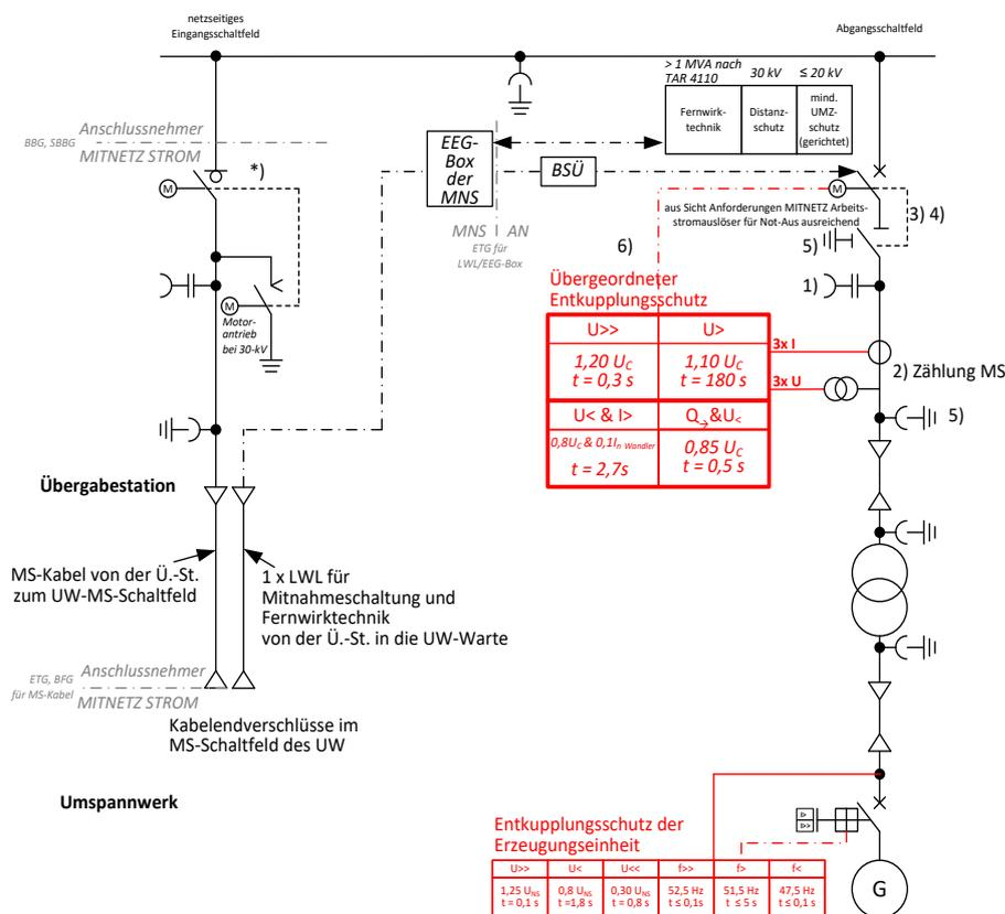
Abb. 25: (ehemals D3a): ≤ 20-kV und 30-kV UW-MS-Sammelschienenanschluss einer Erzeugungsanlage
