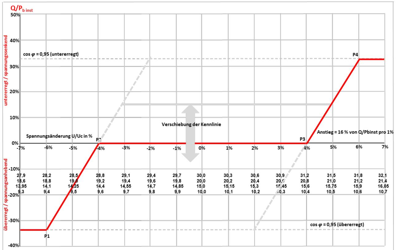
Abb. 15: Standard-Kennlinie Blindleistung mit Spannungsbegrenzungsfunktion, ehemals Bild 10.4
