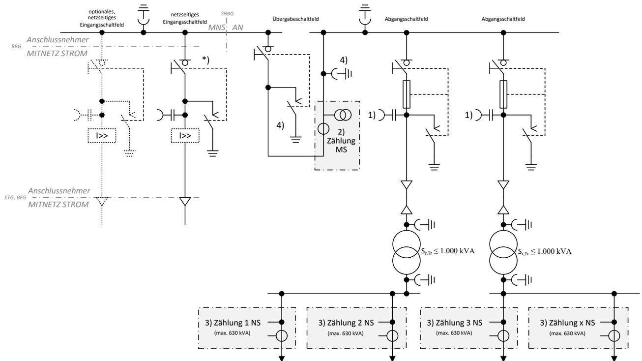
Abb. 23: (ehemals D2a):  $\leq 20$ -kV-Anbindung mit zwei Abgangsfeldern; Transformatoren  $\leq 1$  MVA mit Übergabe-Lasttrennschalter
