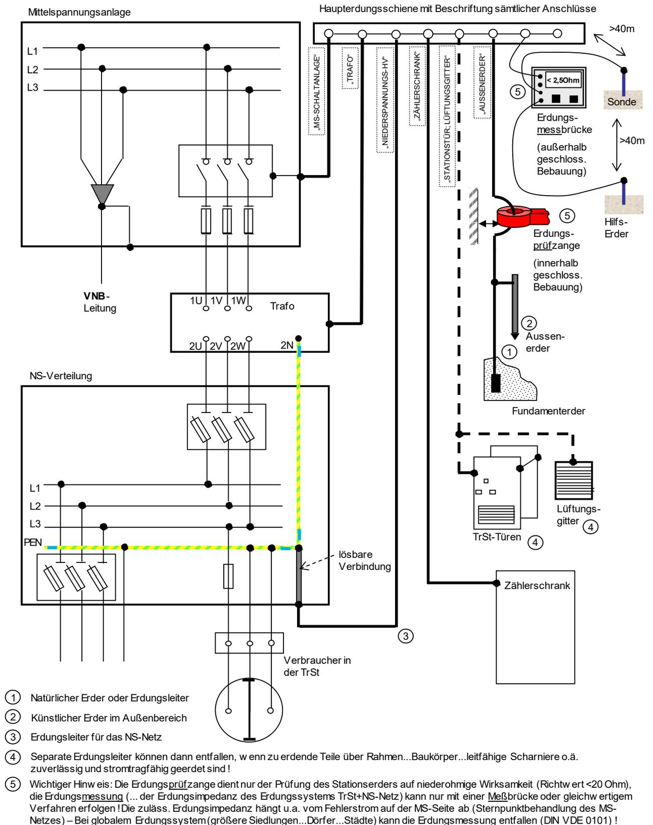
Abb. 8: Gemeinsame Mittel- und Niederspannungs-Erdungsanlage in einer Übergabestation
